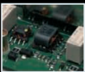
Die 1. Mischstufe sorgt für optimale Empfängereigenschaften
