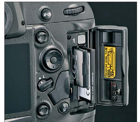
Bild 4: In Nikons Profikamera D4 lassen sich neben herkömmlichen CF-Karten (hinten) erstmals auch die neuen XQD-Speicherkarten verwenden.
