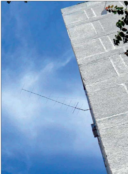
Seine „Balkon-Antenne“ hat Alexej, UN7AX, am Boomende mit einem Gelenk befestigt, sodass er sie händisch im Azimuth ausrichten kann.
