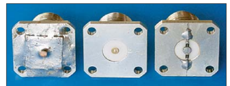
Bild 10: Eigenbau-SOLT-Kalibrierelemente in N-Norm; physikalische Bezugsebene ist die plane Flanschrückseite ( Open –17,62 ps wegen der Endkapazität, Short 0 ps, Delay zur genormten Bezugsebene 43,44 ps).
