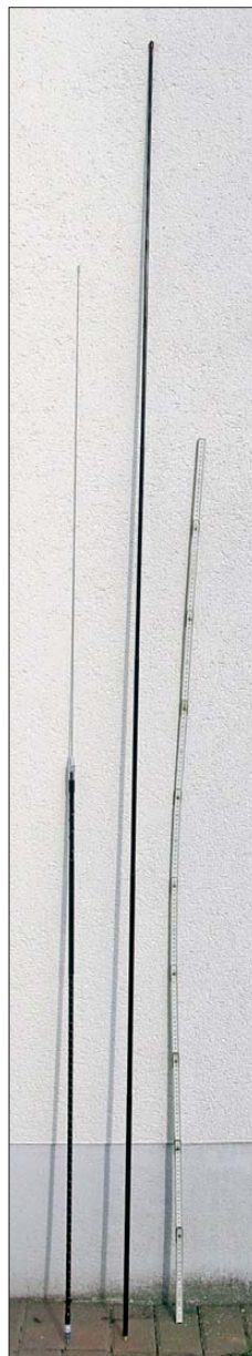
Bild 6: C-Whip-Monoband-Mobilstrahler f6r das 20-m-Band (links) und Teleskopantenne (Mitte) im Gr66envergleich neben einem Gliederma6stab (2 m, rechts) Fotos: DL6RAL
