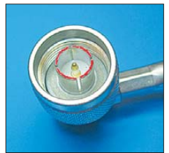
Bild 11: Die genormte Bezugsebene (rot) liegt an der Stoßkante des Außenleiters.
