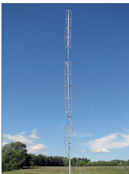
Eine gleichermaßen optisch attraktive wie effiziente Konstruktion: die Quadlongs bei DF7TS/p. Eine einzelne Antenne wiegt mit Anschlusskabel und vertikalem Tragrohr (25 mm Installationsrohr) etwa 1,5 kg, hat 9 dB Gewinn und einen horizontalen Öffnungswinkel von 75°. Details auf www.mydarc.de/dk7zb Foto: DF7TS
